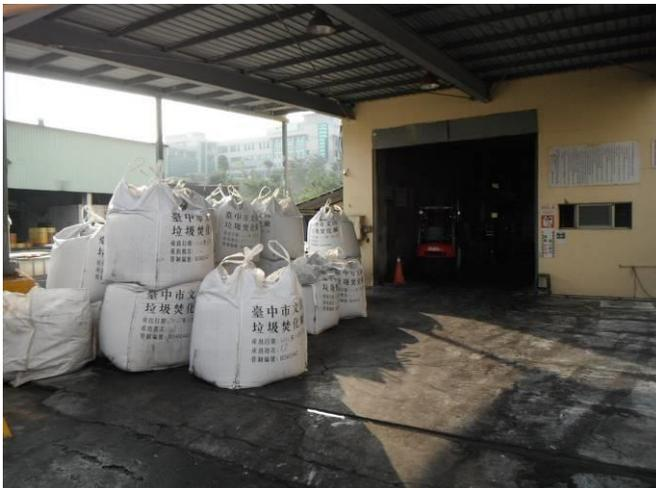
15 飛灰穩定化廠：飛灰加入螯合劑及水泥加以穩定化處理。
