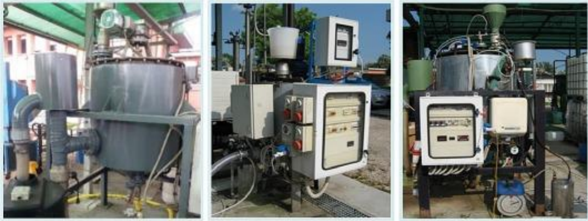
圖 5、左為單一階段系統，中和右分別為二階段系統中的第一和第二階段反應器
