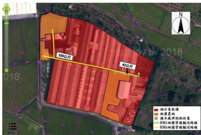
圖 6.1.2-5、○ 全畜牧場管線輸送至施灌地路線圖。
