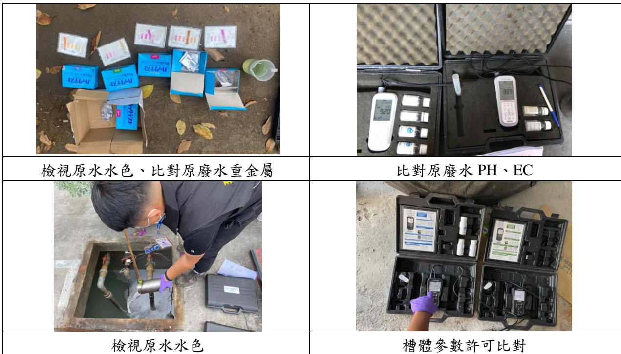
圖 3.1.3-3、原廢水現場調查情形。
