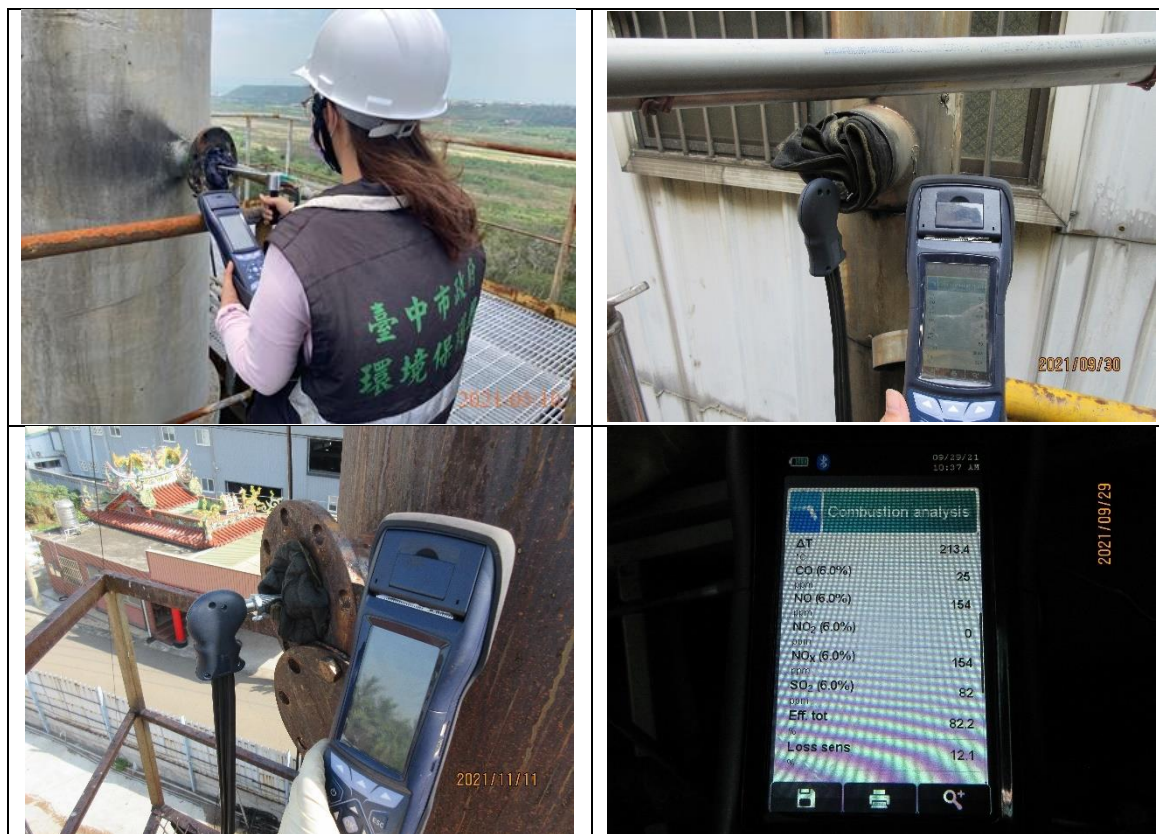
圖 3.3.3-3、手持式煙道氣體分析儀量測情形
