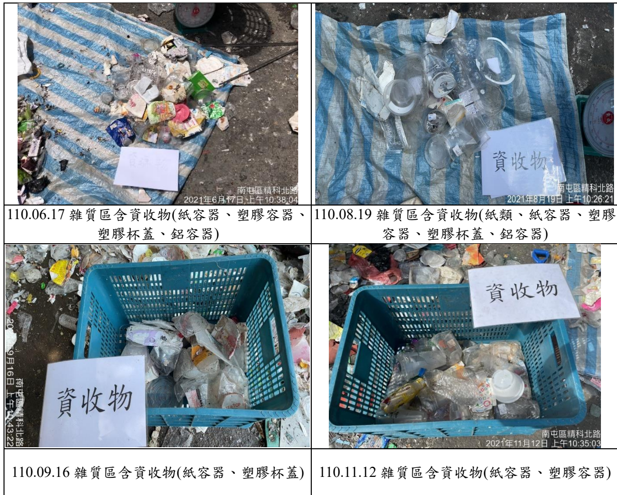
圖 5.3-2 大豐文山站後端雜質區採樣情形(雜質區含有大量回收物)
