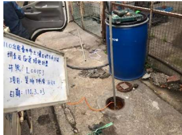
F.執行井況評估作業-微水試驗
