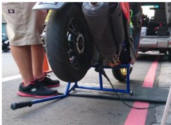
圖3.2.1-11 橡膠墊及駐車架(機車用頂高器)
