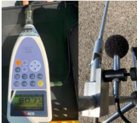
圖3.2.1-10 機動車輛噪音檢測所需儀器設備示意圖
