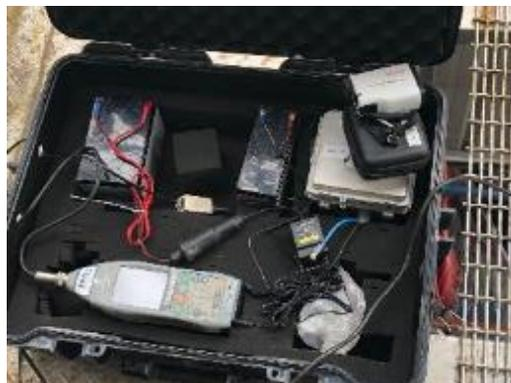
圖3.1.1-2 噪音監測儀器
