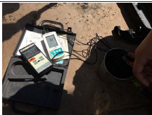
現場進行原廢水 pH 值及導電度量測
