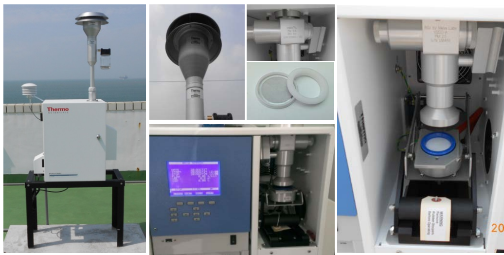
圖 3.1.1、Thermo 2000i 手動採樣器採樣設備
