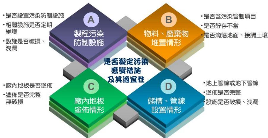
查證前的現場勘查與輔導目的，主要為瞭解確認工廠內可能的土壤、地下水污染潛勢區域，並以蒐集之背景資料及現場勘查結果，提出污染預防輔導建議，以降低污染情事發生的機率。本計畫藉由工廠輔導勘查過程，並留意是否有潛在污染源，尤其著重於工廠製程區廢污水集水坑、集流管線、分匯流方井、地下管線、儲槽、製程區截流溝等均為可能發生污染問題之處。
