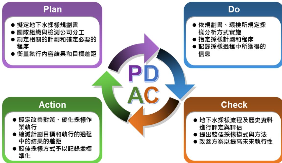
圖 4.4-2 監測井地下水採樣-PDCA 管理流程圖
