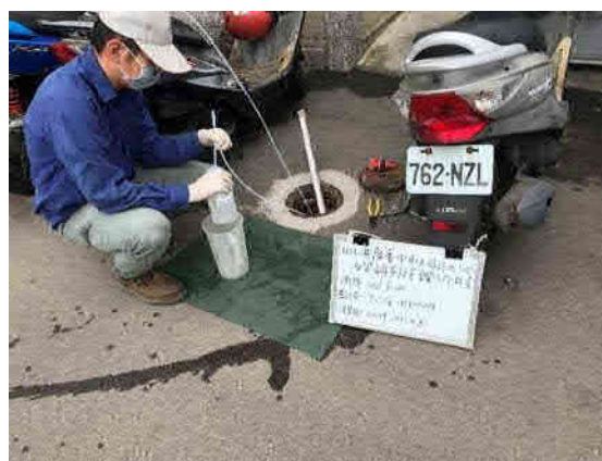
地下水採樣狀況
