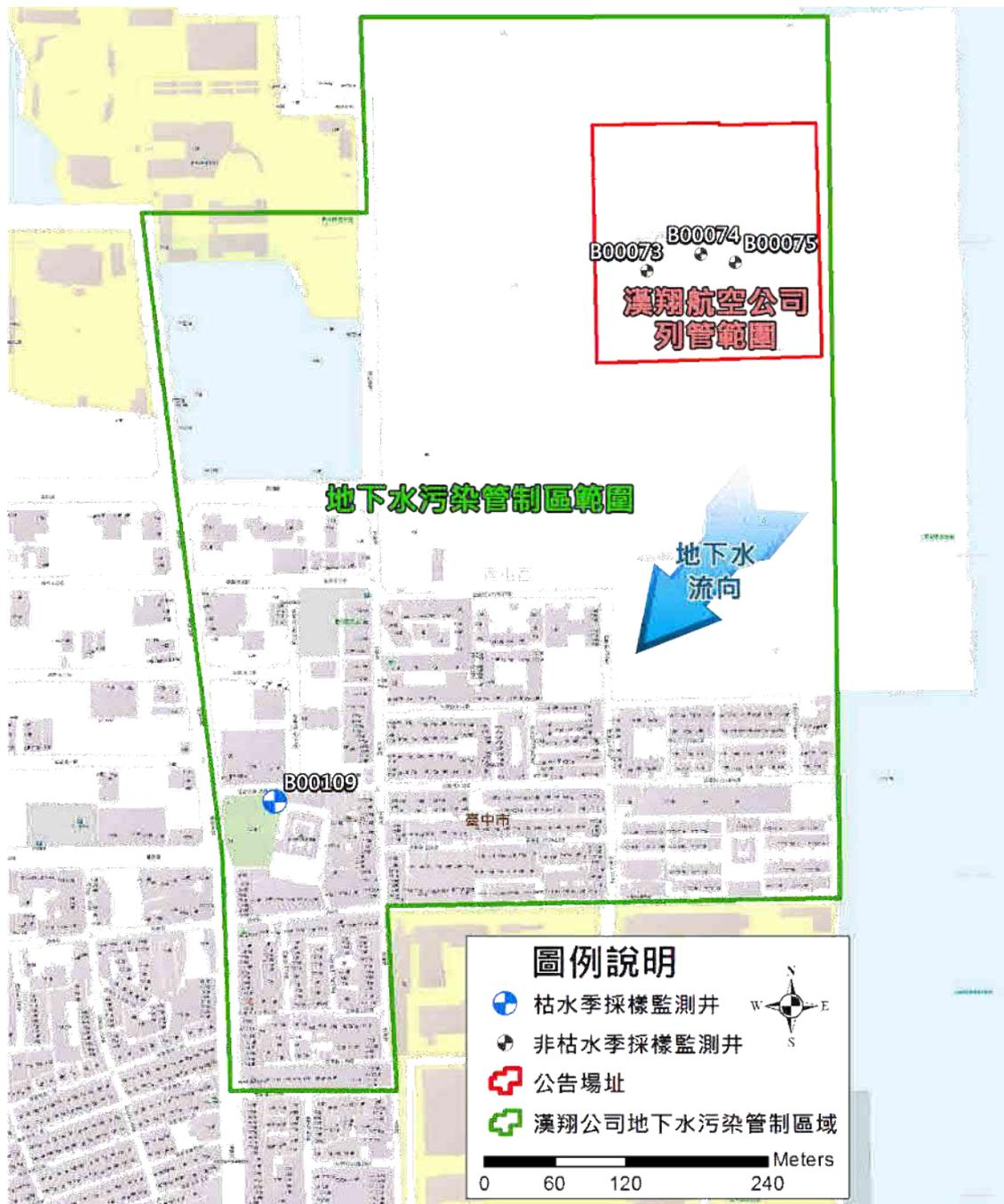
圖 4.3.8-1 漢翔航空公司地下水流向與枯水期採樣監測井位置分佈
