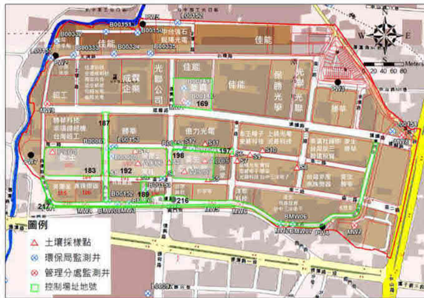
圖 3.3.1-1 加工出口區臺中園區控制場址與土壤及地下水監測點位圖
