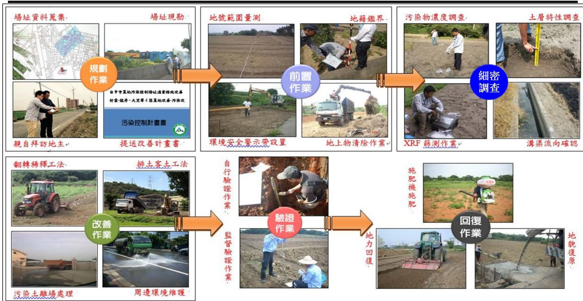
圖 2.1-1 整理污染改善作業流程
