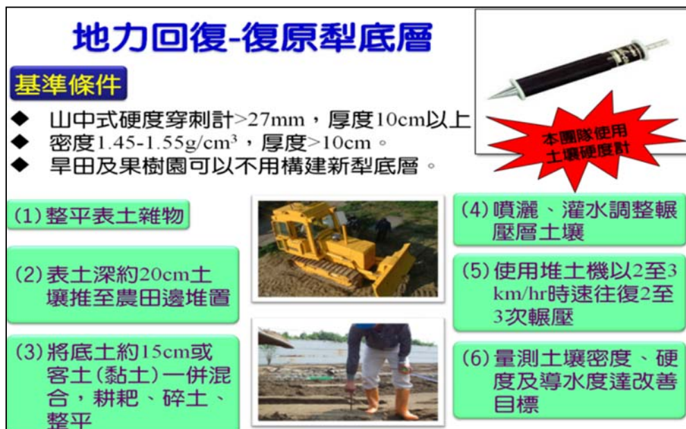
圖 2.2.7-1 犁底層回復參考作業程序
