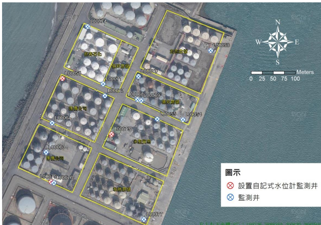
圖 4.4.1-2 設置自記式水位計之監測井
