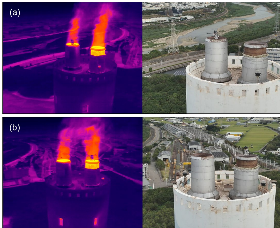
圖 4.29 本團隊無人機於烏日焚化廠採樣紅外線影像與可見光影像。(a).北煙囪採樣
