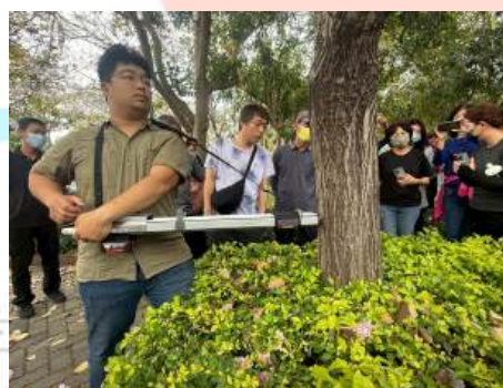
利用阻抗儀檢測檢查 樹木內部有無中空腐
