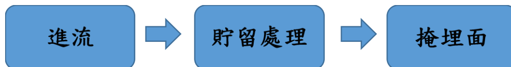
圖 2-2 后里區掩埋場水質處理程序簡易流程圖
