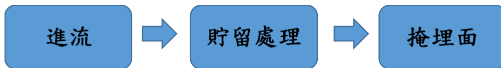
圖 2-8 大甲區復育掩埋場水質處理程序簡易流程圖
