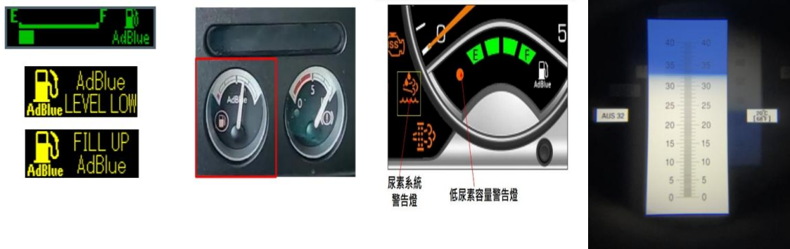
圖 3.5.3-3、各式尿素水液位指示燈/警告燈及測試(範例)
