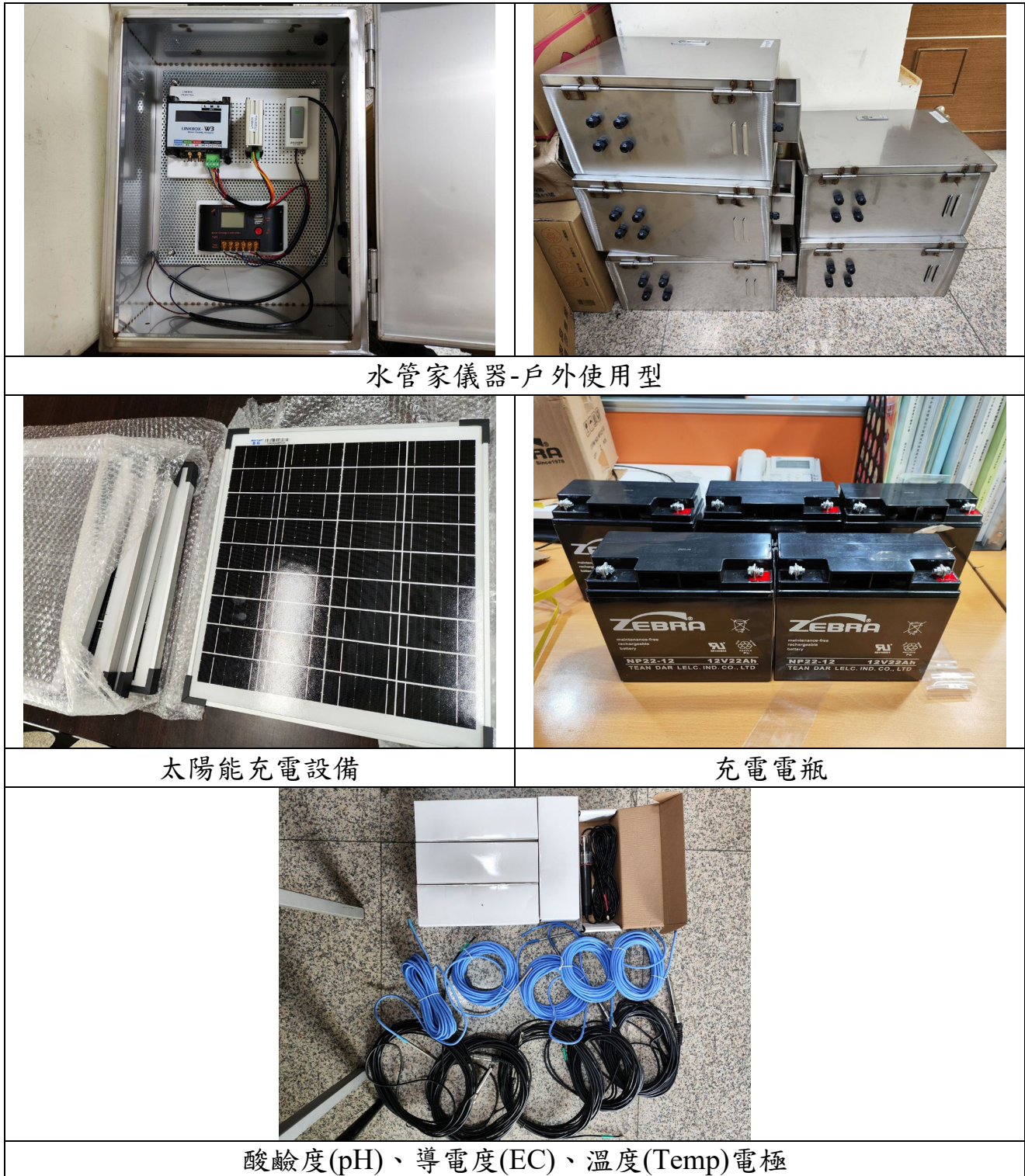
圖 3.1-1 水質自動監測感測元件設備
