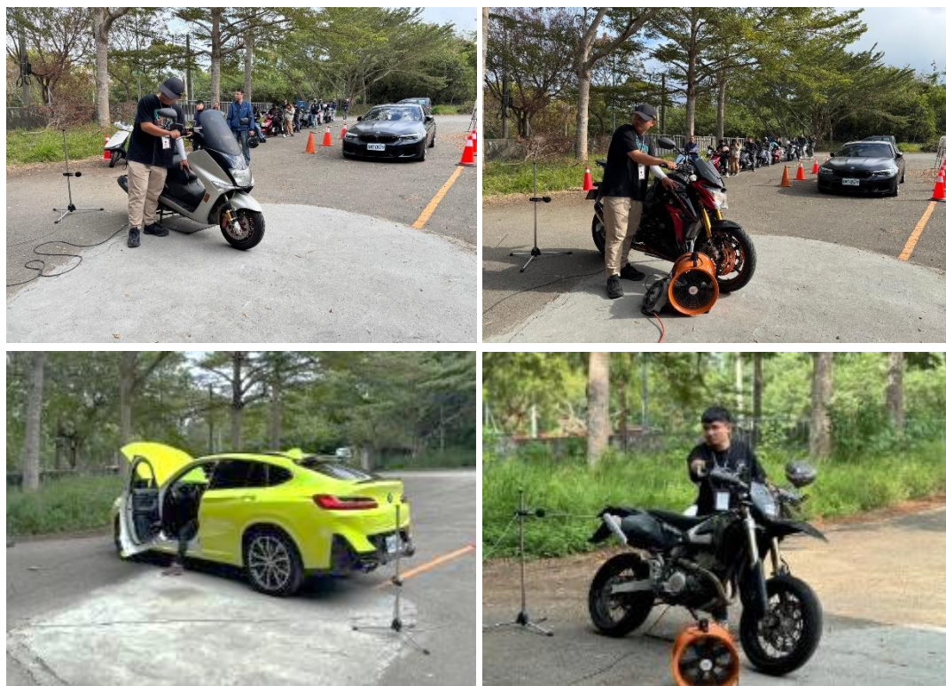
圖 3.2-5、噪音檢測現場作業情形
