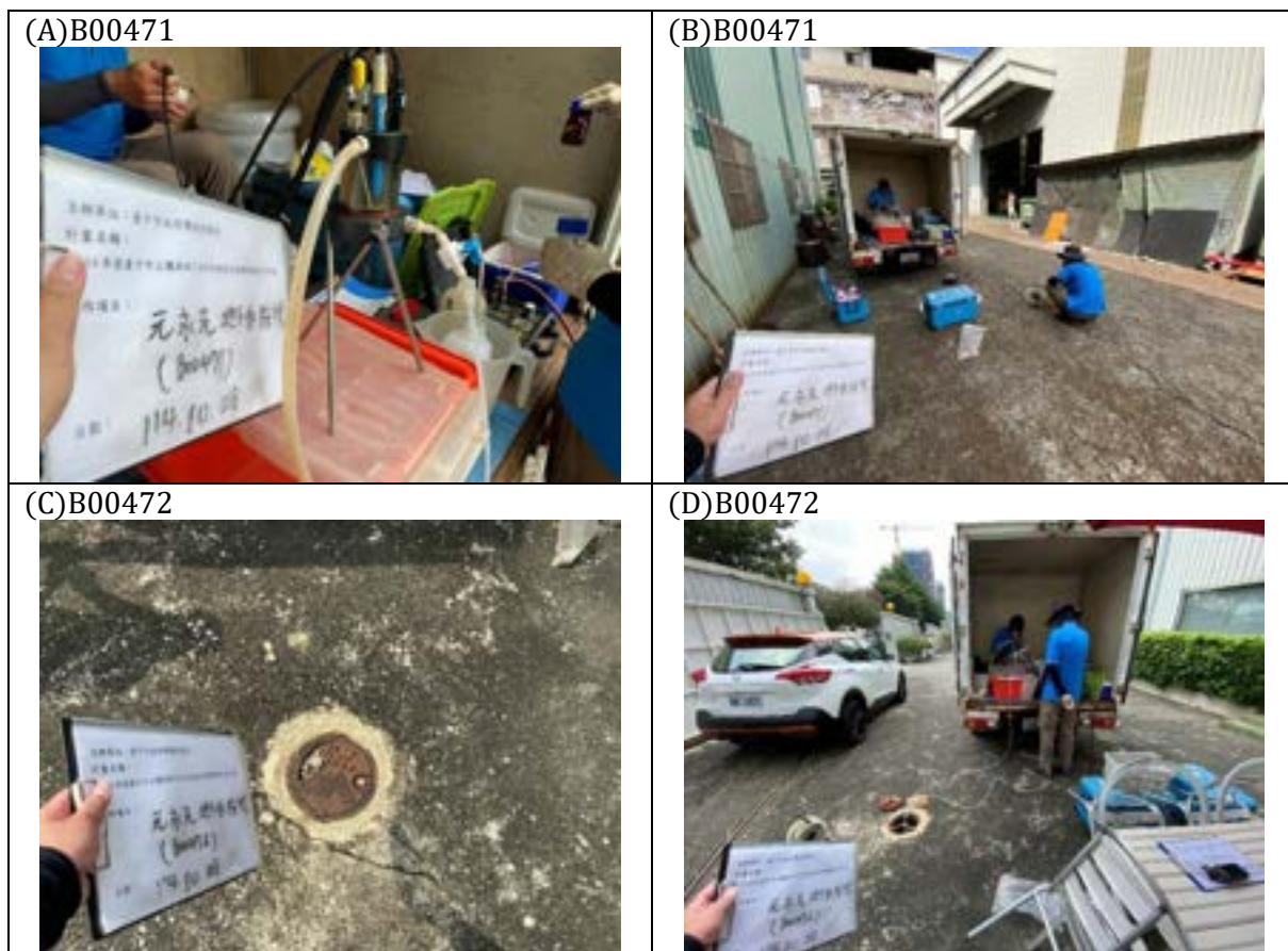
圖 5.2.2-1 本計畫 B00471、B00472 監測井地下水採樣作業過程
