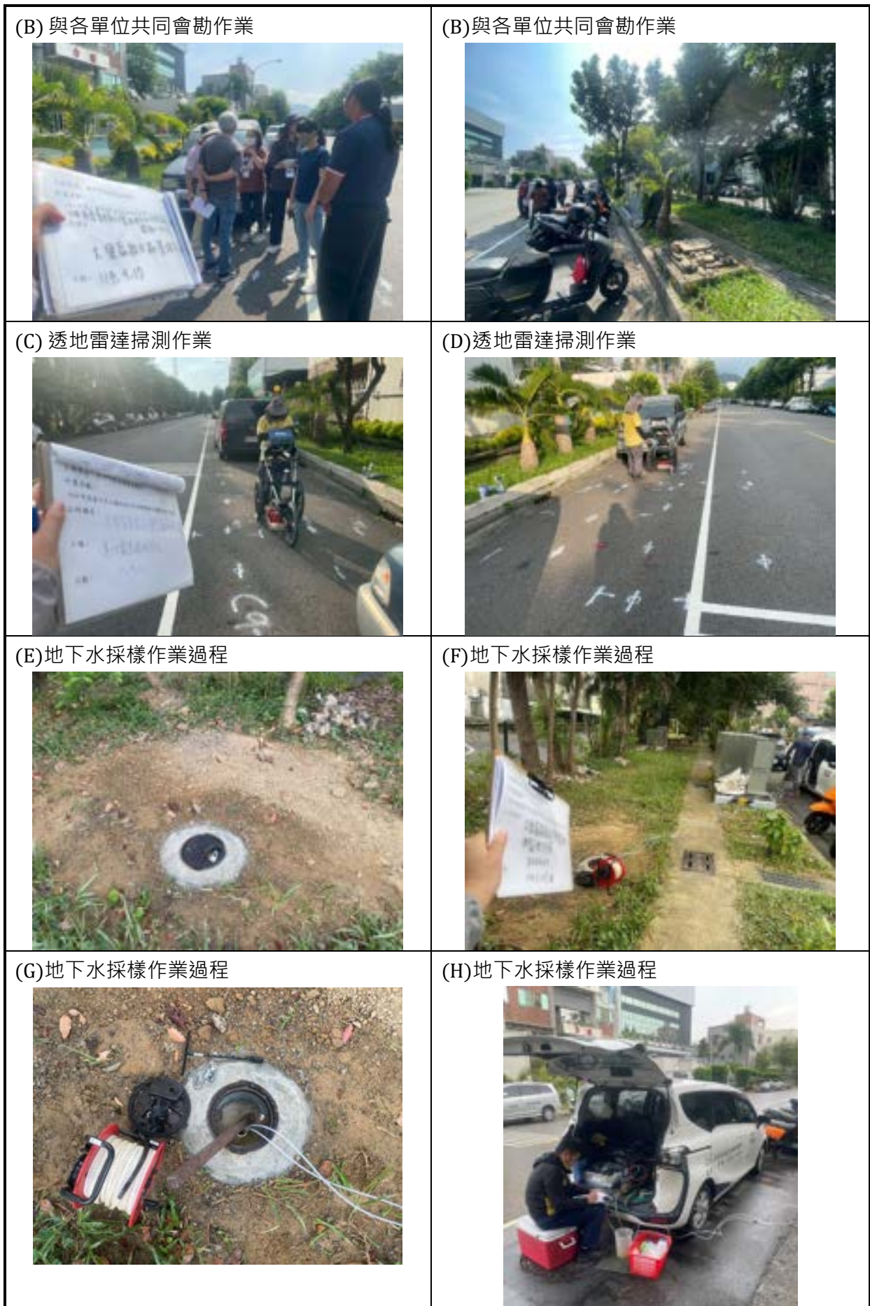
圖 4.3.4-2 大里產業園區 B00623 監測井設置前地下管線確認及地下水採樣過程
