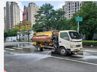
道路洗掃作業
