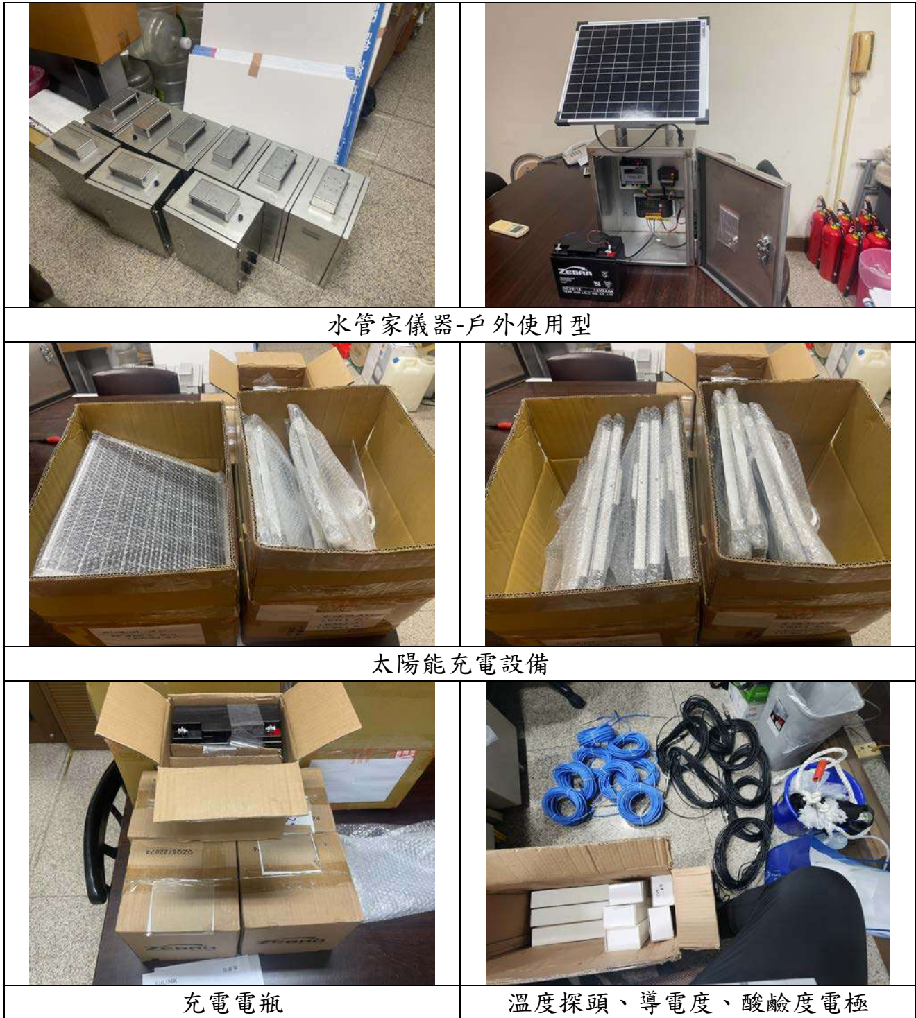
圖 3.1-1 水質自動監測感測元件設備
