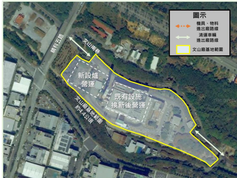
圖 6.2-6 文山廠汰舊換新工程後規劃動線
