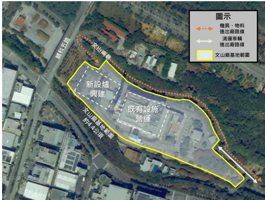
圖 6.2-4 新設爐興建期規劃動線
