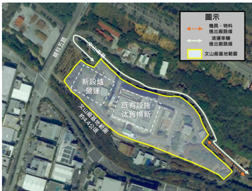
圖 6.2-5 既有設施汰舊換新工程期規劃動線
