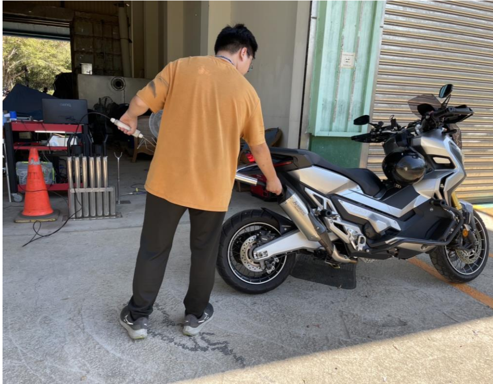
圖 4.3-2 機車不定期排氣檢測現場業情形
