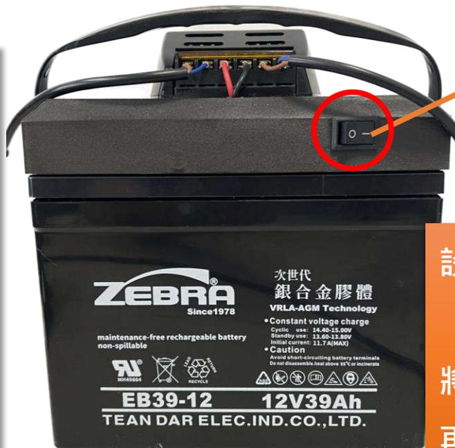
設備線路都接好後，開啟開關後才能「打開」太陽能板，要收拆線前要先將太陽能板「收合」後，再關閉開關，再拆線，避免太陽能控制器 短路
