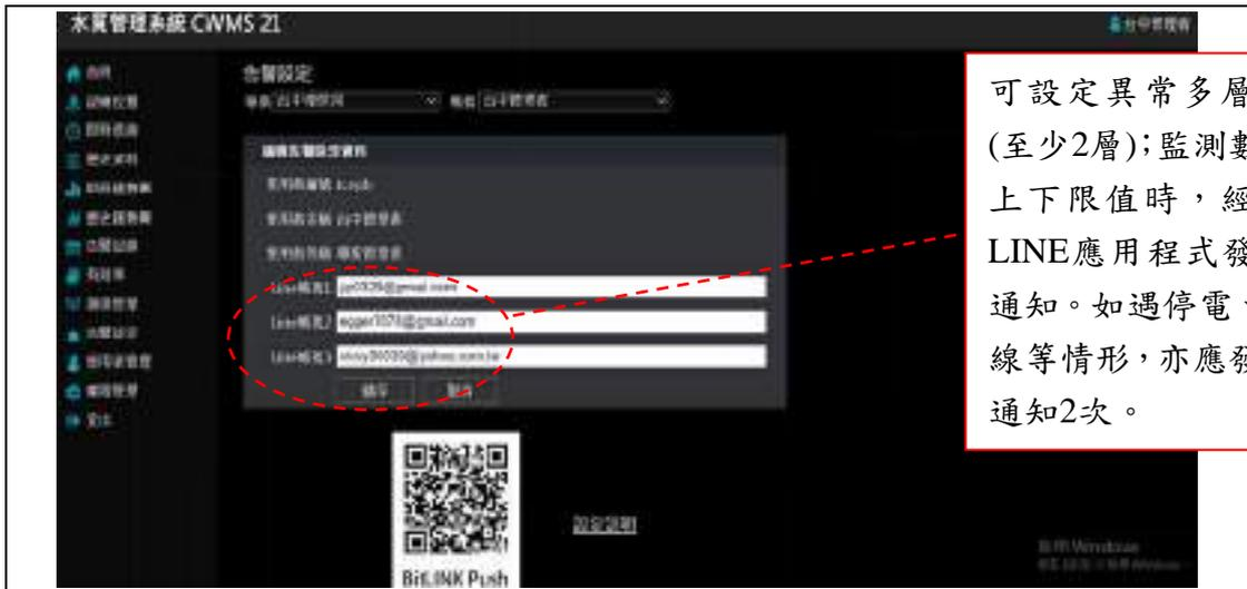
可設定異常多層級警報(至少2層);監測數據超過上下限值時,經由手機LINE應用程式發送告警通知。如遇停電、設備斷線等情形,亦應發送告警通知2次。
