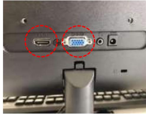
5. 含顯示器一台，顯示介面 1 x D-Sub 及 1 x HDMI。設備規格書如附件四所示。
