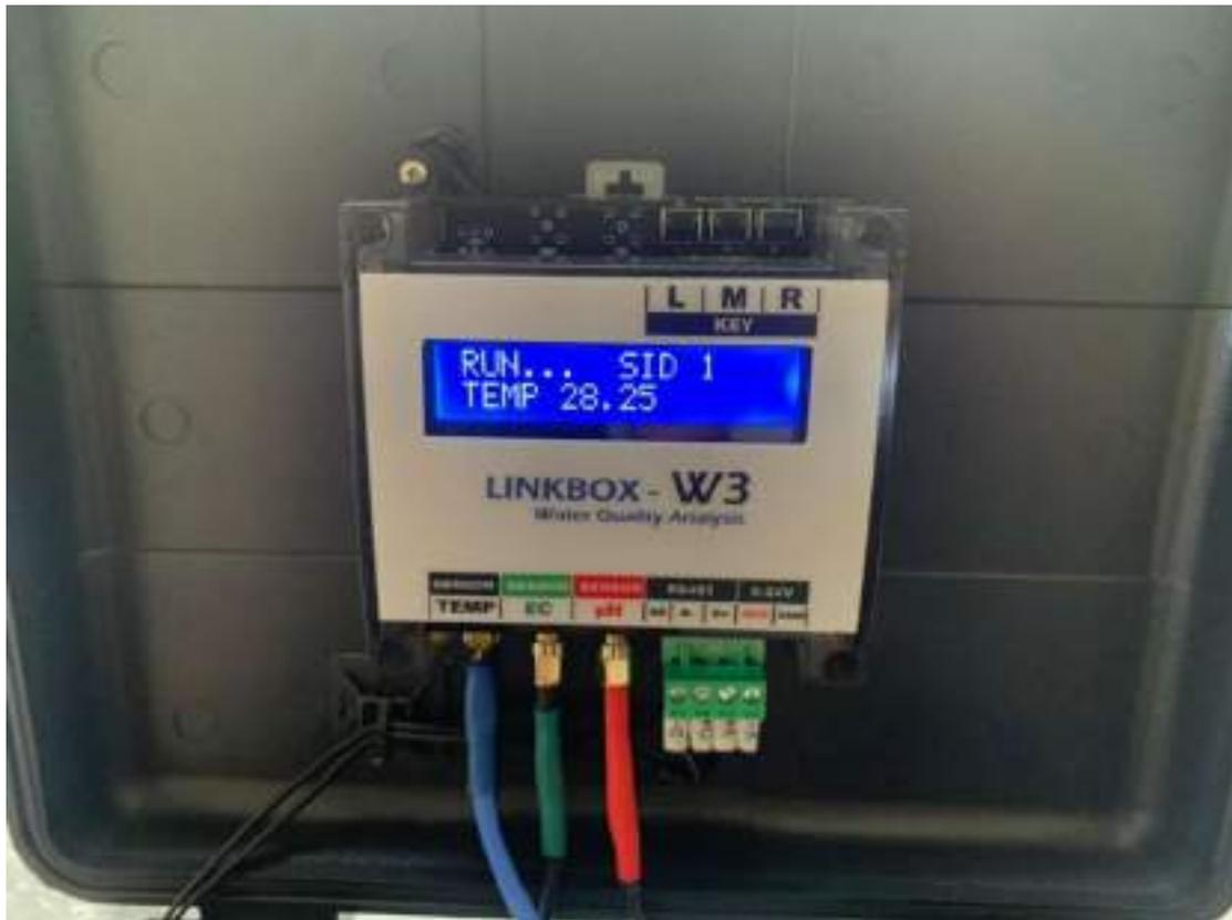
(五) 具有無線通訊傳輸模組，可將感測元件偵測數據進行傳輸利用，可選擇支援 4G、5G、LPWAN、LTE CATM1 等多種 IoT 無線通訊功能之一，並可透過更換無線通訊模組方式轉換無線通訊功能以利日後升級。
