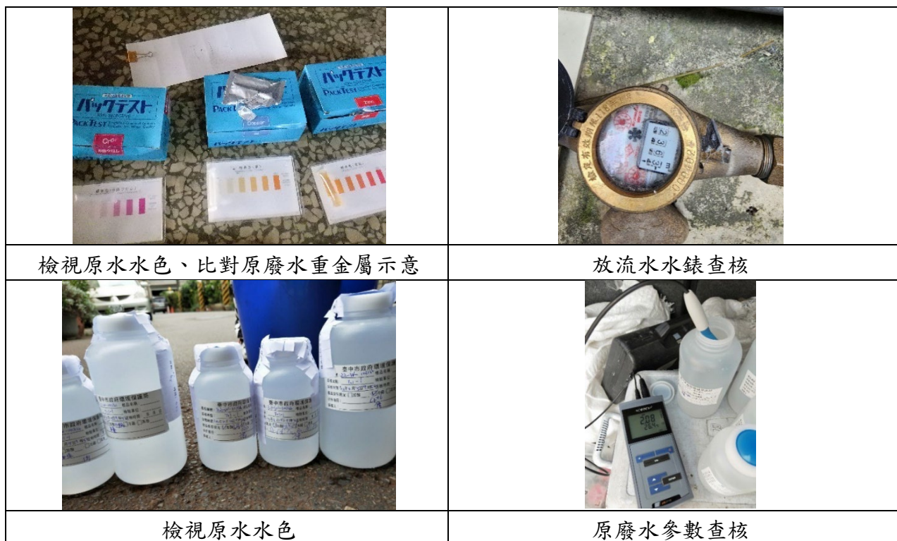
圖 4.1.3-2、原廢水現場調查情形
