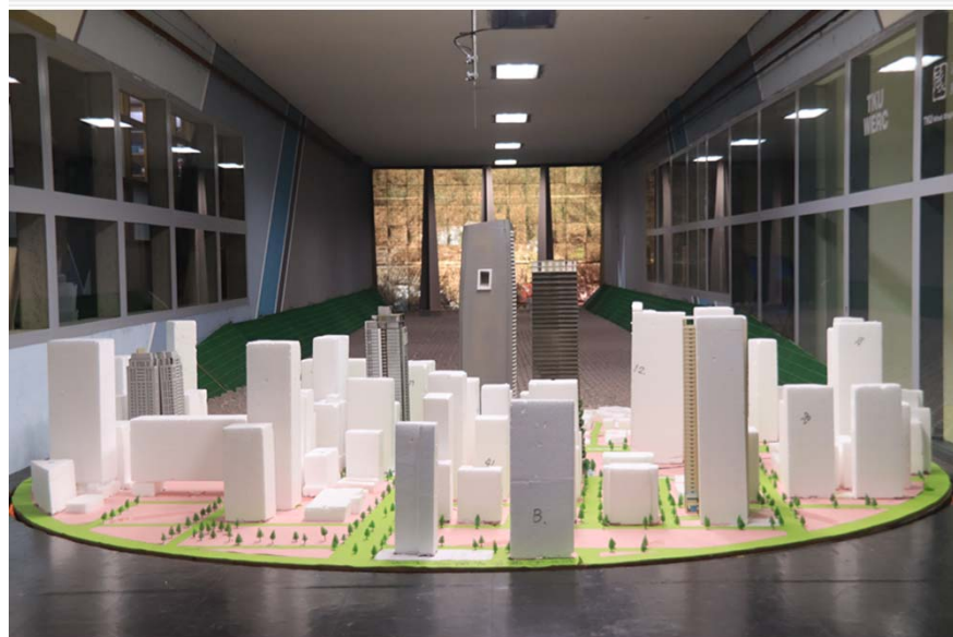
風洞試驗主模型與周圍地形佈置情形
