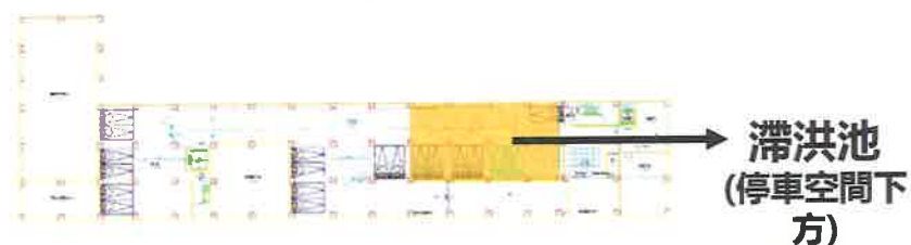
滯洪池配置圖(地下一層)
