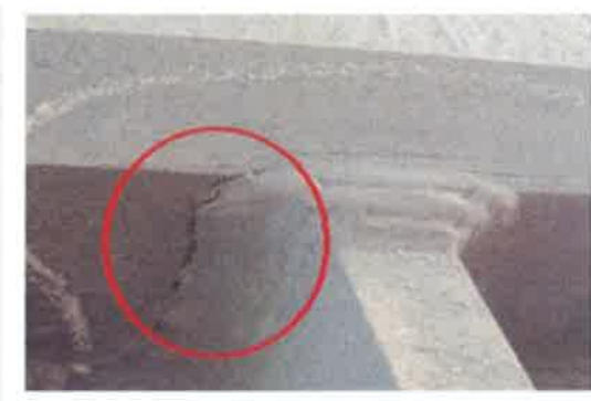
圖 2. 成品儲槽外部焊道龜裂情形及漏粉位置
