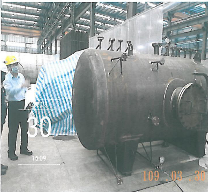
槽體外觀檢查
