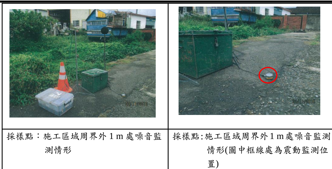
圖 7.3-2 第二次周界噪音及振動監測情形
