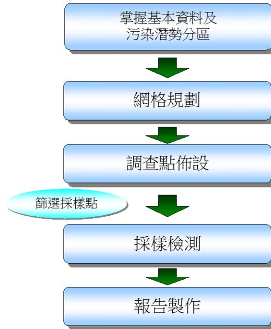
圖一、網格法土壤採樣調查整體作業流程
